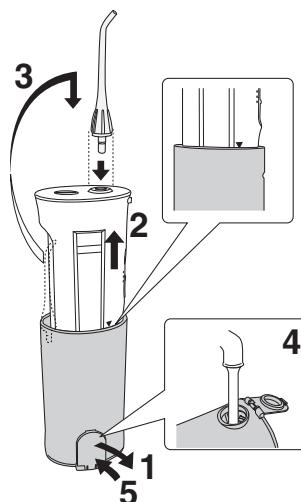
**3** Вставьте насадку в разъем для установки насадки, придерживая основной блок за его белую часть.
